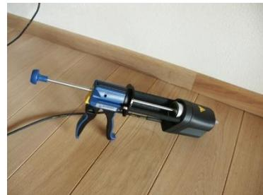
Reaktivní PUR tavná lepidla se zpracovávají pomocí vyhřívaných kartušových pistolí. Teplota zpracování leží v rozsahu 120°C až 140°C.
